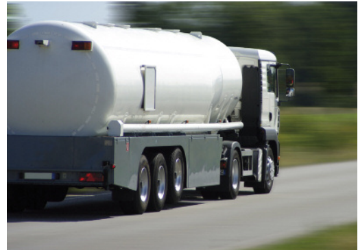
Futtermittel-Transporte: Silo-Fahrzeug mit ca. 30m 3 Volumen für den Futtermitteltransport
